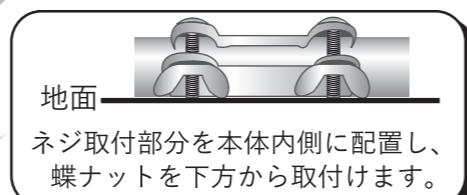
(4) 脚用パイプをパイプジョイントに差込みます
