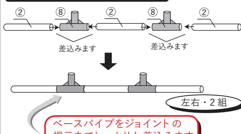
(3) 先に組立てた各パイプをパイプジョイントで組みます
