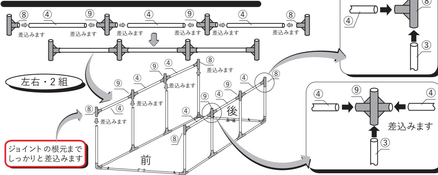
(6) アーチパイプ・天井通しパイプをパイプジョイント⑩・⑪に差込み天井部を組立てます。
