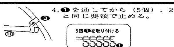
2. ⑧の下端より約10cm上に⑩のパイプが来る様に、③の部品でしっかりと止めて、(蝶ネジはシート保護の為内側へ) ①を5個通す。
