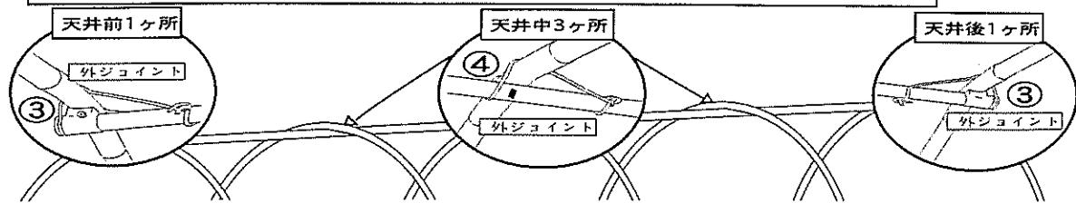
左右2組 アーチ・脚パイプの継ぎ目に 4 で付けた印を合わせて取付ける
