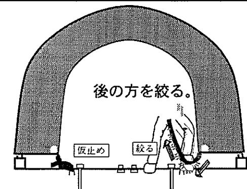
片方を仮止めして、もう片方のロープをフラットバーのリングに通して、ロープを足で踏みながら、引き上げる様に絞り天幕のハトメに通して結び止める。
